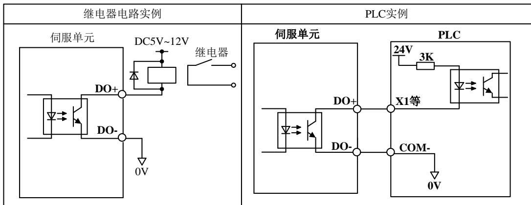
**注：**光电耦合器输出电路的最大容许电压、电流容量如下所示。
