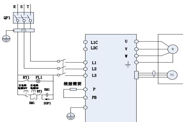
QF1: 断路器; RY1: 继电器; FIL: 噪音滤波器; PL1: 显示灯; SUP1: 抑制器; KM1: 电磁接触器
