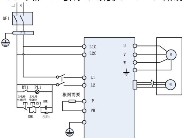
QF1: 断路器; RY1: 继电器; FIL: 噪音滤波器; PL1: 显示灯; SUP1: 抑制器; KM1: 电磁接触器
