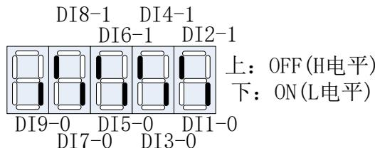
请确认输入端子与输入信号之间的关系。
